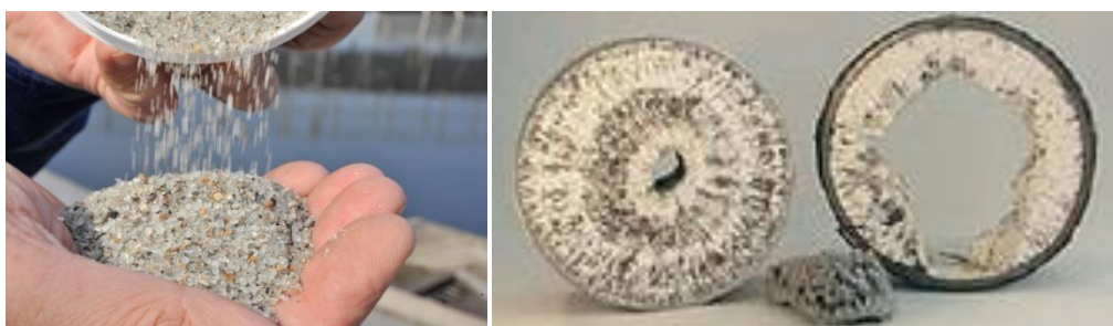
Afbeelding 1: Teruggewonnen struviet (links) en verstopt leidingwerk (rechts) (foto's afkomstig uit [1]).
