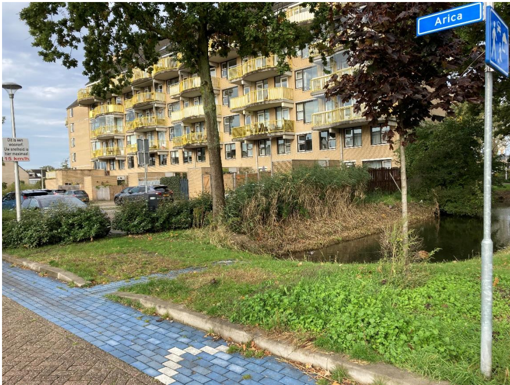
Afbeelding 1. Voorbeeld in Capelle aan den IJssel waarbij verhard oppervlak is afgekoppeld en het hemelwater direct naar de oever van een watergang wordt geleid. (bron: gemeente Capelle aan den IJssel)
