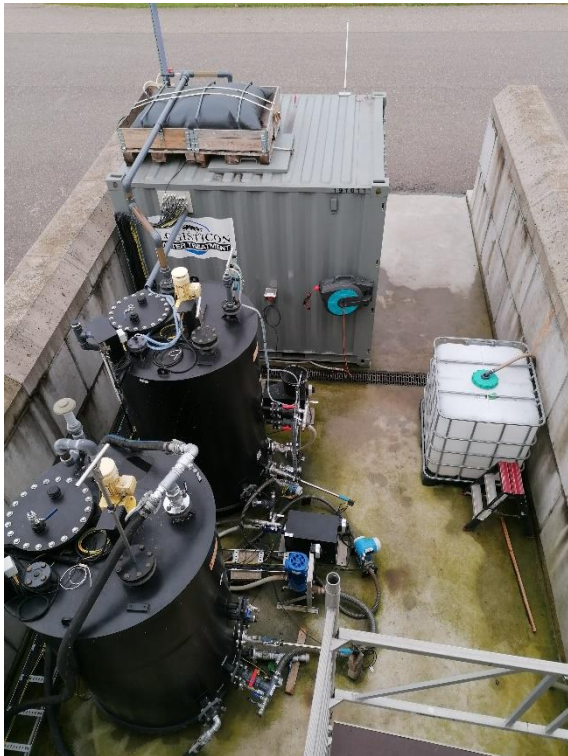
Afbeelding 1. Pilotopstelling voor verzuring van zeefgoed en primair slib
