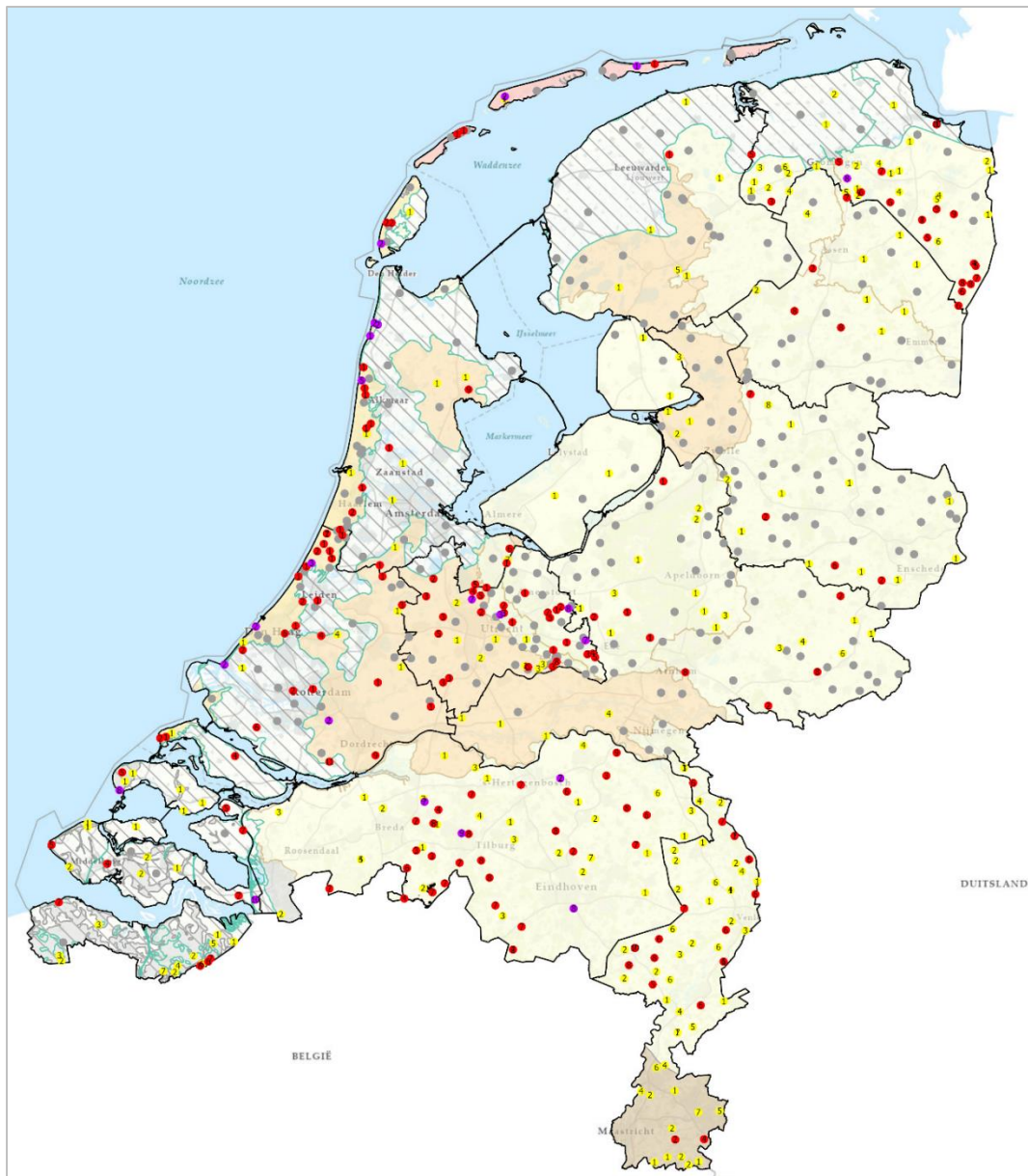
Afbeelding 3. Aangetroffen van PFAS in het ondiepe grondwater. Per filter is weergegeven hoeveel van de geanalyseerde PFAS-stoffen zijn aangetroffen boven de rapportagegrens (cijfer), of één of meer stoffen normoverschrijdend zijn aangetroffen (rood, of paars bij één of meer overschrijdingen van meer dan 10x de norm), of wel stoffen zijn aangetroffen maar geen enkele stof de norm overschrijdt (geel), of dat géén van de geanalyseerde stoffen is aangetroffen (grijs gearceerd)
