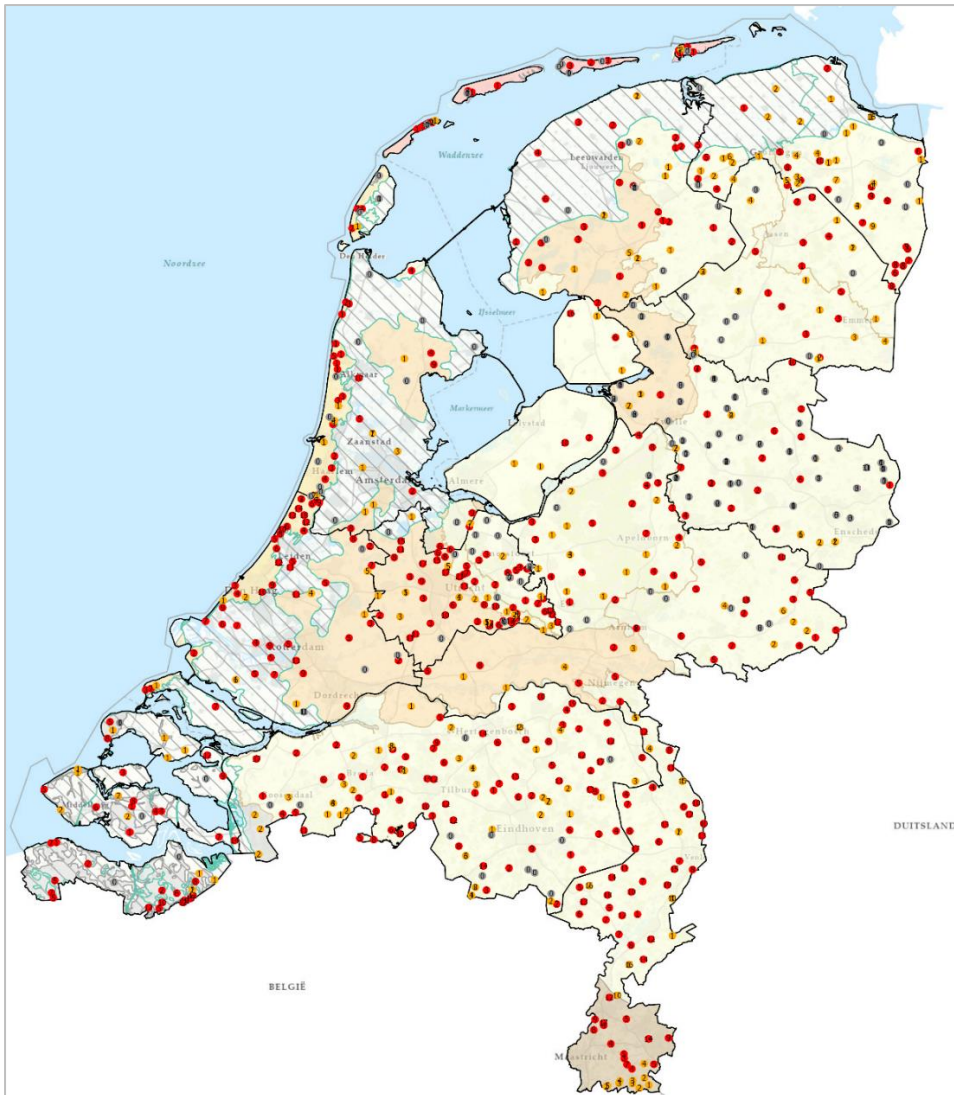
Afbeelding 2. Aangetroffen milieuvreemde stoffen in het ondiepe grondwater in Nederland. Per filter is weergegeven hoeveel van de geanalyseerde milieuvreemde stoffen zijn aangetroffen boven de rapportagegrens (cijfer), of één of meer stoffen normoverschrijdend zijn aangetroffen (rode punten), ofwel stoffen zijn aangetroffen maar geen enkele stof de norm overschrijdt (oranje), of dat géén van de geanalyseerde stoffen is aangetroffen (grijs gearceerd)
