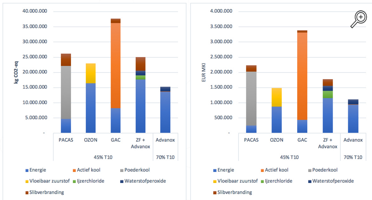
Figuur 1. Milieu-impact in kg CO 2 -equivalent (links) en MKI (rechts) voor Advanox, GAC, Ozonatie en PACAS voor 70% omv reductie voor standaard STOWA toepassing voor een transmissie van 45% T10 en 70% T10 (alleen Advanox).
