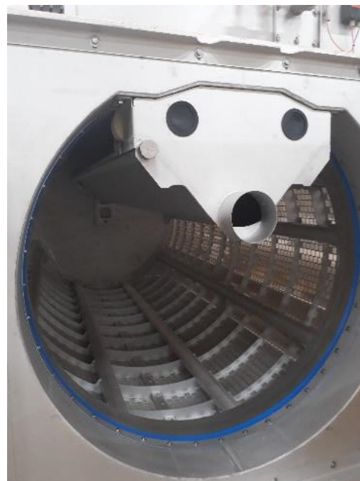
Afbeelding 3. Links: positionering van een trommelzeef op rwzi Leidsche Rijn. Rechts: binnenaanzicht van de korf van een trommelzeef, met bovenin de opvanggoot
