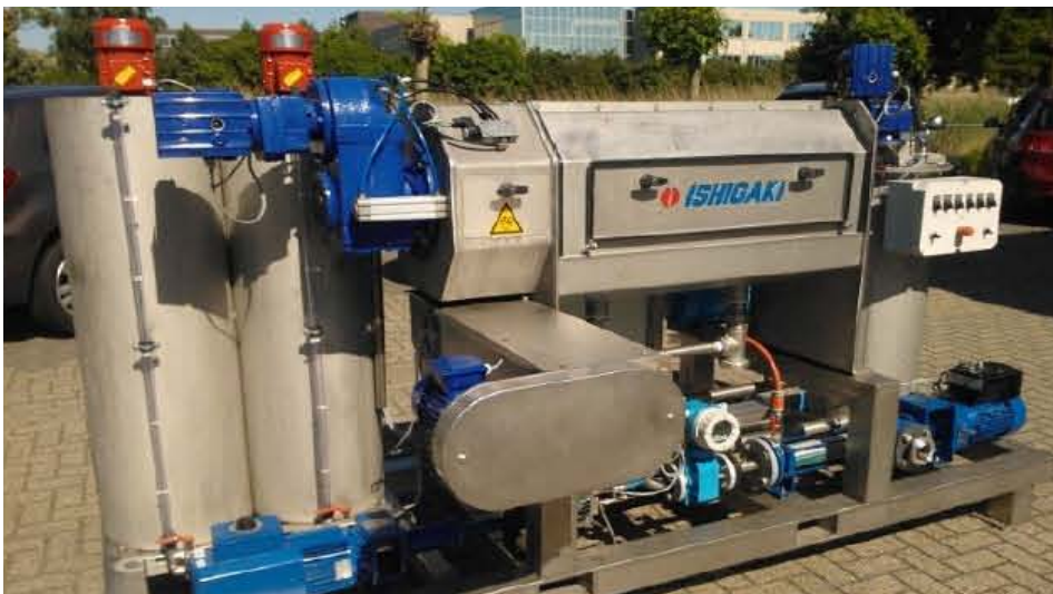
Afbeelding 1. Schroefpers en PE installatie die gebruikt is voor de kleinschalige testen
