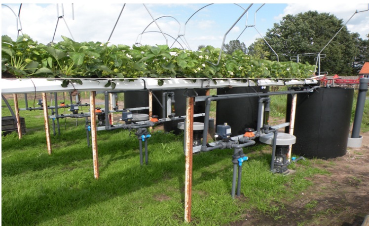
Afbeelding 5. Teeltsysteem type 4: op stellingen met NFT (aardbeien)
