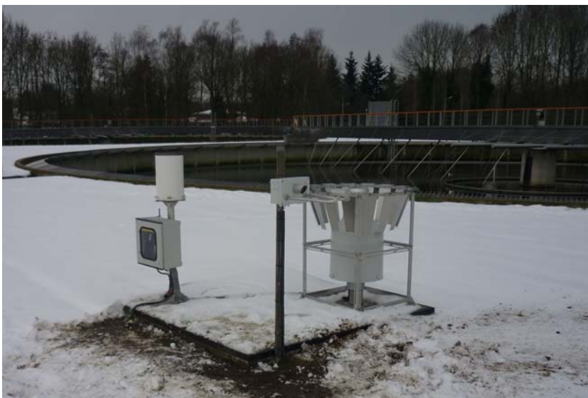
Afbeelding 1. Testopstellingen grondstation voor neerslaganalyse op rwzi Eindhoven Meetmethodes: kantelbakjes (links op de foto), gravimetrisch (rechts) en optische druppelteller (midden).
