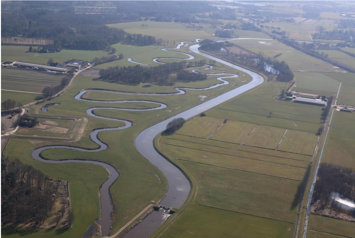
Afbeelding 2. Een hersteld traject van de Essche Stroom waarbij de gekanaliseerde loop behouden is als hoogwatergeul [3].
